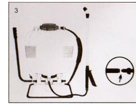
Conecte la palanca de bombeo a uno de los terminales de la misma en la base del fumigador (hay un conector izquierdo y uno derecho). Mueva la palanca de bombeo para aplicar presión.
