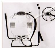
Retire el pequeño sujetador de la correa para los hombros e introduzca el doblez de la correa a través del orificio de la parte superior del cuerpo del estanque
