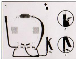
Acople la pistola a la lanza y ajústela, luego atornille el otro extremo de la pistola rociadora al conector de la manguera.
